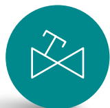
Vanne d'équilibrage Strangreguliertventil mit fester Messblende
