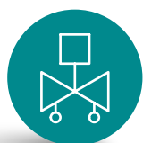
Vanne de contrôle et d'équilibrage à orifice variable Regel und Strangreguliertventil mit variabler Messblende
