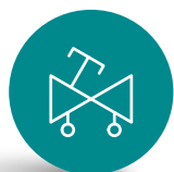
Vanne d'équilibrage à orifice variable Variable orifice balancing valve
