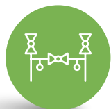
Vanne de raccordement pour unités terminales avec vannes d'isolement intégrées Anschlussventile für Endgeräte mit integrierten Absperrventilen
