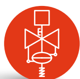
Vanne d'équilibrage automatique avec contrôle indépendant de la pression Automatisches druckunabhängiges Regelventil
